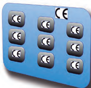
Figura 1: Bloques de una máquina formada por 9 componentes, todos con el marcado CE. La práctica " CE+CE=CE " podría automáticamente adjudicar el marcado CE a la máquina completa: no es correcto.
