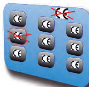
Figura 3: Si alguno de los componentes incorporados a la máquina no es conforme y no tiene el marcado CE, la máquina completa tampoco será conforme y no podrá llevar el marcado CE
