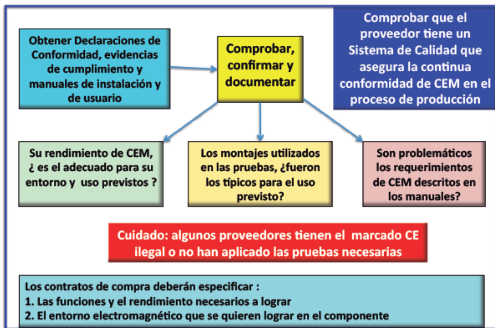
Figura 3: Gestión de la calidad de la CEM en los componentes a incorporar en la máquina
