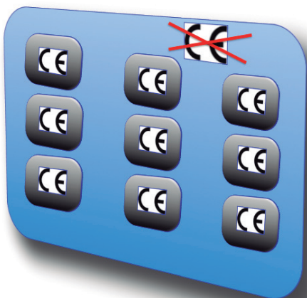
Figura 1: Si se realizan las pruebas de CEM de la máquina completa, casi seguro no cumplirá, aunque todos sus componentes cumplan. Si alguno de los componentes no cumple, la máquina completa tampoco cumplirá
