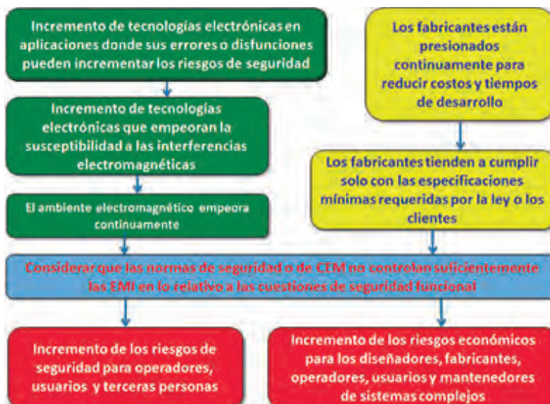
Figura 1: Incremento de los riesgos en un sistema complejo debido a las EMI
