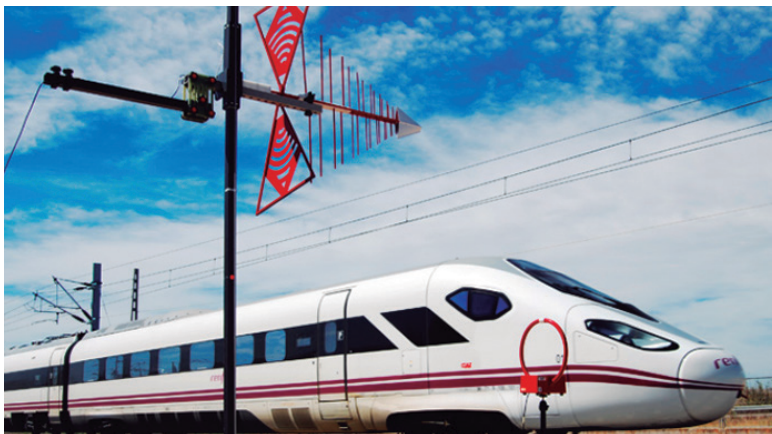
Figura 5. Las medidas de las emisiones radiadas con varias antenas necesitan varias pasadas del tren.
