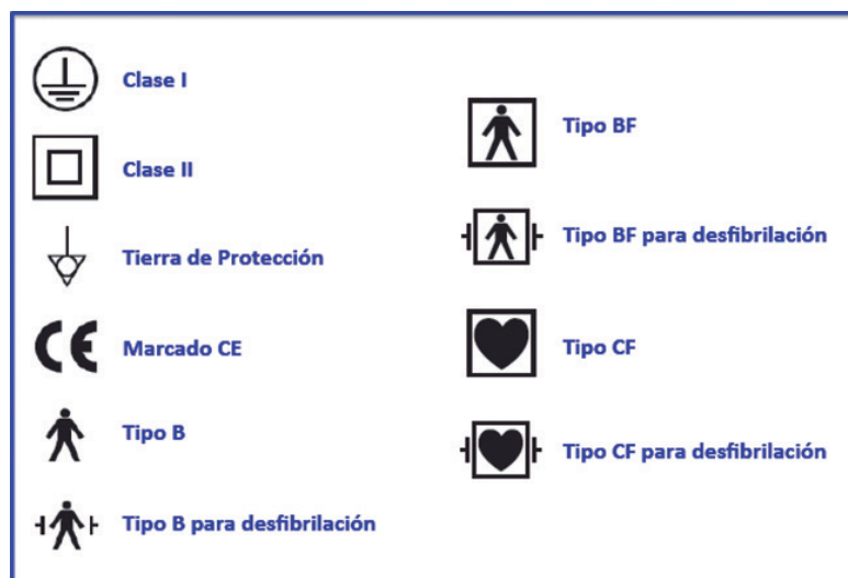
Figura 1: Algunos de los símbolos más destacados para identificar el tipo de equipo electromédico de acuerdo al nivel de protección, siguiendo la norma EN 60601-1.
