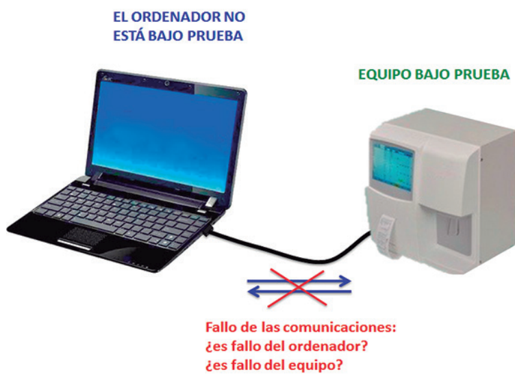
Figura 1. Equipo controlado desde un ordenador PC vía una comunicación USB.
