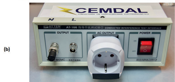
Figura 9. (a) carga formada por una bombilla de filamento controlada con un regulador con triac (b) Red de Estabilización de Impedancia de Línea (LISN)
