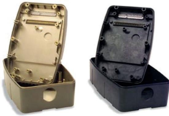
Figura 7. Molding de cajas de plástico metalizadas con diferentes materiales usando un proceso de inyección de plástico con polvo o fibra metálica, que elimina la necesidad de una posterior metalización superficial.
