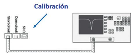
Figura 1. Imagen medida [S11] en analizador vectorial (VNA).
