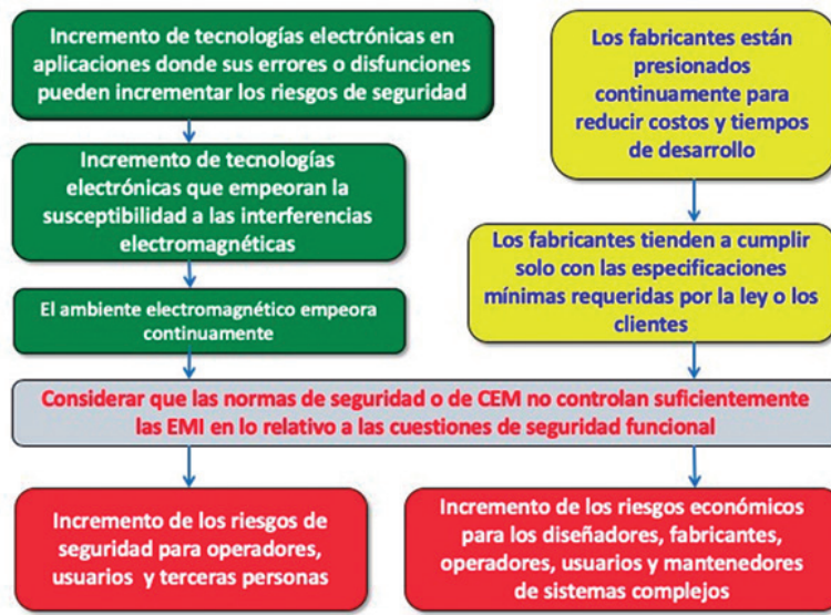
Figura 6. Incremento de los riesgos en un sistema complejo debido a las EMI.
