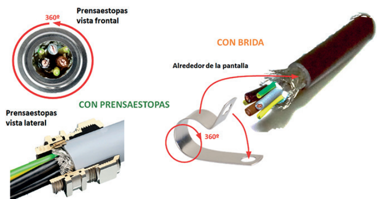
Figura 1. Terminación de la pantalla a 360° con prensaestopas y con brida.
